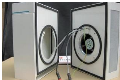
Dispositivo ISO 200 com montagem na janela, vista sobre ambos os lados do filtro e ventilador, conexões por cabo, tubo para pressão diferencial, juntas, parafusos de montagem
