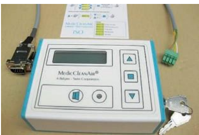
Controle remoto com chave e tela de pressão diferencial, cabo com tomadas de ligação, manual de instruções sucinto para funcionários do hospital (enfermeiros-chefe, departamento técnico, etc.)
